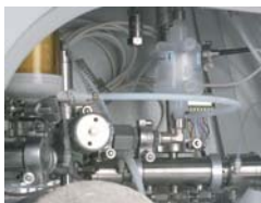
Diaphragm valve in AISI 316 L stainless steel with pneumatic actuator & decontamination of exhaust air with sterile filter / Valvola a membrana in acciaio AISI 316 L con attuttore pneumatico e decontaminazione dell'aria di scarico con filtro sterile
